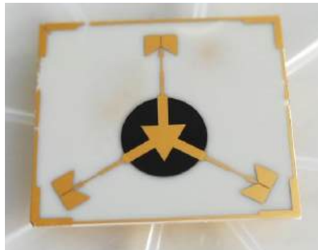
Figure IV-38 Substrat ferrite diélectrique métallisé du circulateur bi-bande micro-ruban
