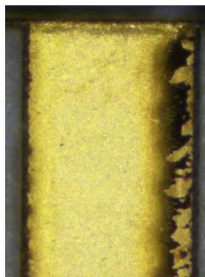
Figure III-32: Traces de brûlures sur l'échantillon dû à la puissance élevée délivrée par le laser
