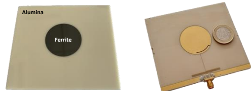
Figure 4. Substrat de ferrite-alumine et l'antenne fabriquée après la métallisation et la gravure laser.
