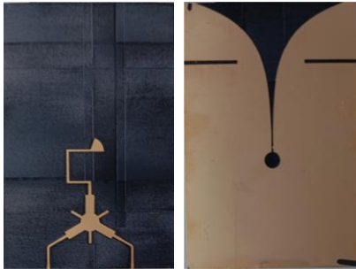
Figure 7. Photographie du circulantenne large bande.
